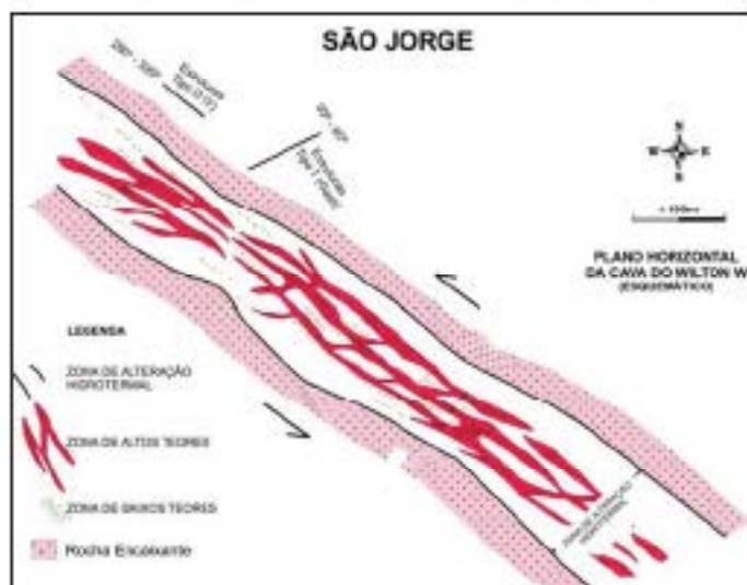
Fig. 4- Interpretação em bloco diagrama das duas direções principais de veios mineralizados do depósito aurífero São Jorge e os corpos de alto teor em forma de charute formados na interseção das duas direções. Fonte: Talon Metals Corp.
