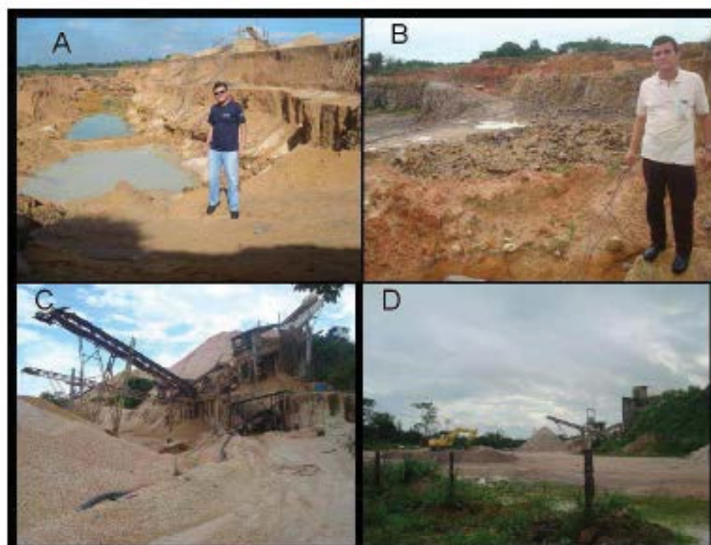
Figura 2: A – Extração de seixos; B – Extração de granito para brita; C – Lavagem de seixo; D – britagem do granito e seleção
