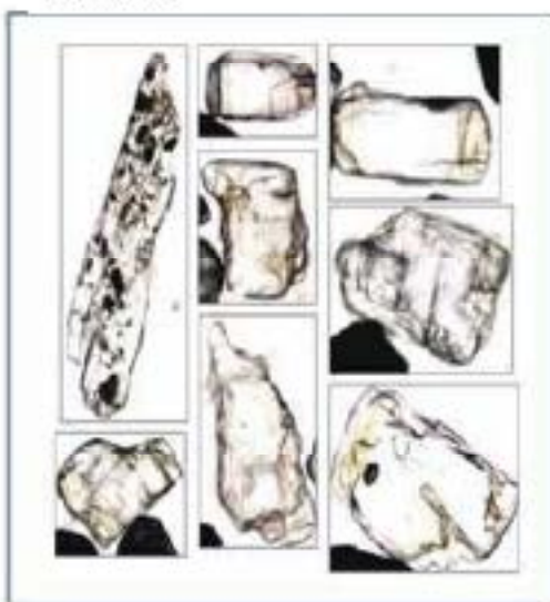
Figura 4: Fotomicrografias dos grãos de cianita.
