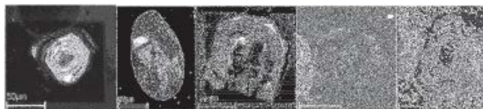
Figura 3: Zonamento composicional em grãos de zircão de rochas sedimentares da Formação Solimões no estado do Acre. Imagens obtidas por catodo luminescência em ICP.
