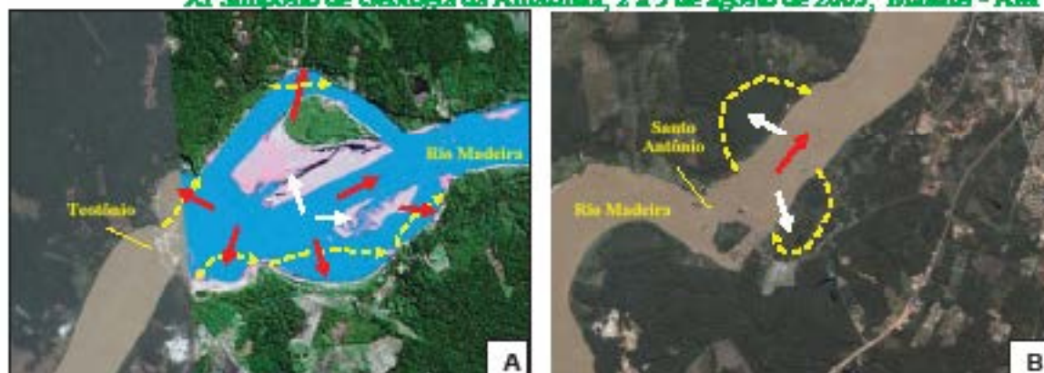
Figura 5 - Caudaltes de Teotônio (A) e Santo Antônio (B), no Rio Madeira. Setas em vermelho indicam as áreas com predominância de erosão, as setas em branco as áreas com predominância de deposição e as linhas tracejadas amarelas os limites aproximados das principais áreas de erosão e de deposição nas imediações das cachoeiras.
