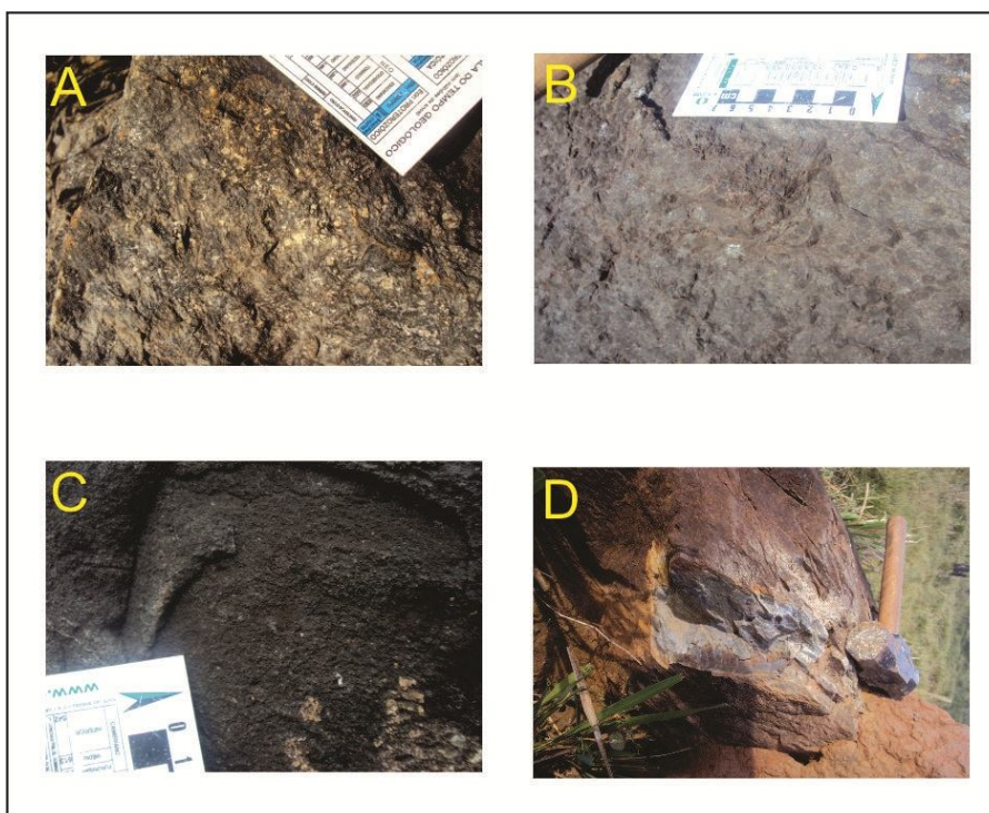
Figura 2 – Sequência de Diferenciação magmática encontrada em campo: A - Dunito; B – Piroxenito; C – Gabro; D – Anortosito.
