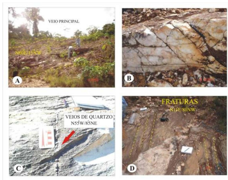
Figura 1: (A) veio de quartzo principal; (B) clivagens de fratura no veio de quartzo principal; (C) veio de quartzo, encaixado em metarenito; (D) padrão de fraturamento.
