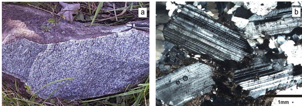
Figura 2 – Aspectos macro e microscópico da Suíte Trairão. (a) Bandamento composicional conferido pela presença de banda tonalítica e banda monzogranítica; (b) Foliação magmática marcada pela orientação preferencial de cristais subédricos de plagioclásio. O quartzo encontra-se parcialmente recristalizado. Polarizadores cruzados
