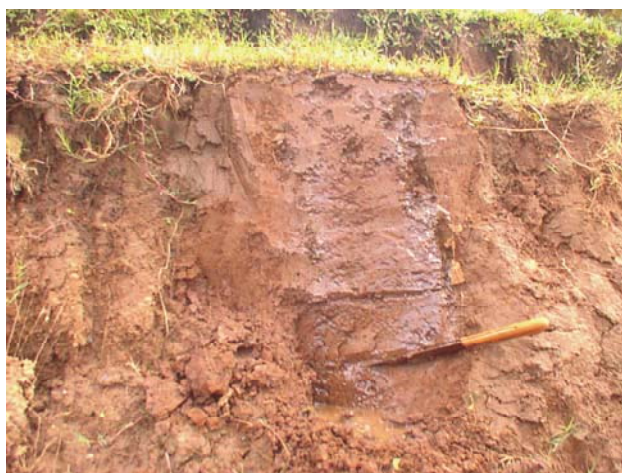
Figura 02 – Corte realizado para mensurar a profundidade alcançada (23 cm) pela gasolina em 12 horas.
