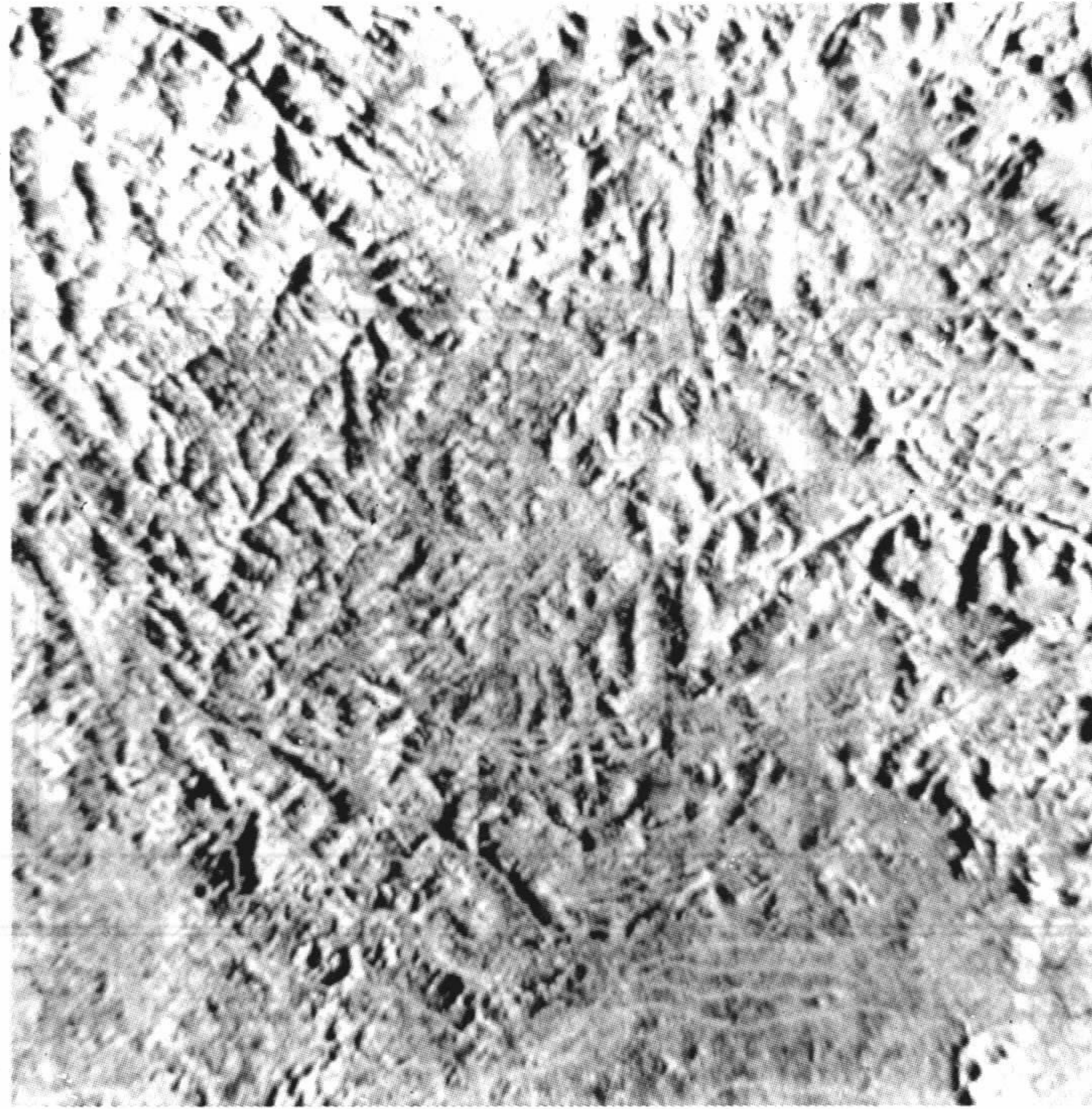
Foto 01 - Imagem Radar mostrando lineamentos longos (> 2 Km.). Os dados vetoriais do mapa geológico são mostradas em cores claras. Original colorido.
