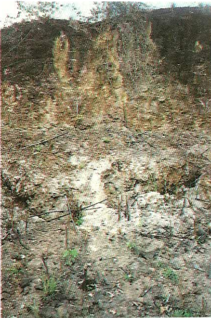
Figura 3 - A) Fotografia mostrando a seção geológica típica do Km 29 da Belém-Brasília próximo a Mãe do Rio. As unidades foram individualizadas na Figura 2; B) Detalhe da crosta ferruginosa inferior colunar sobreposta quase diretamente sobre o horizonte de caulim.
